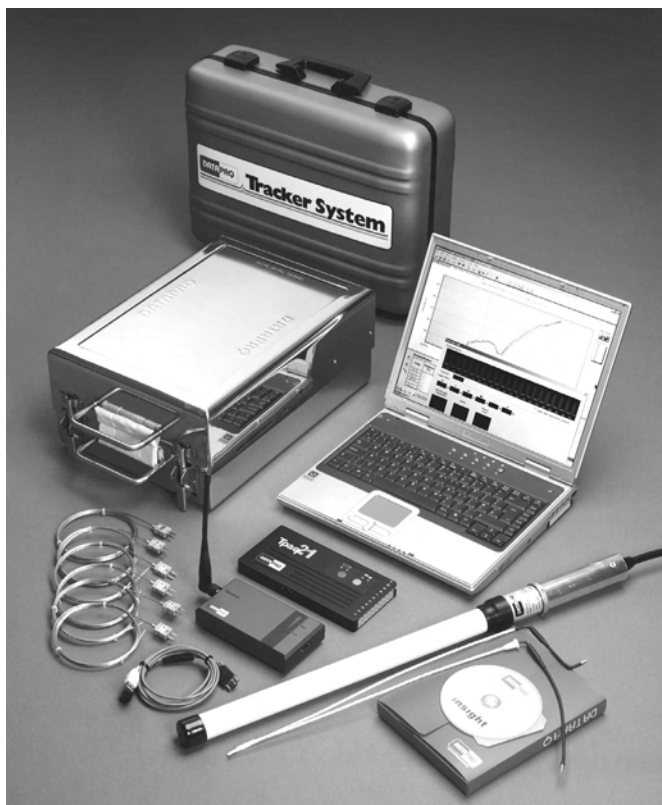
高温炉温度跟踪仪的无线电遥测系统：Tpaq21 记录器和带有鞭状天线的接收器（中）、单位增益端部馈入接收天线及两个发射天线（右下）
